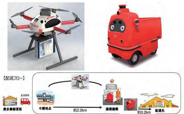
図19 ドローンと配送ロボットを使用した DX 物流
